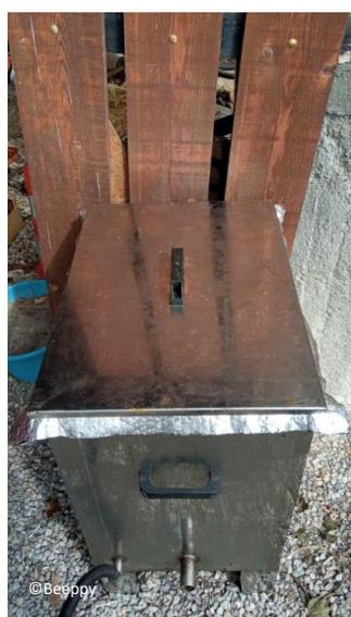
Cette chaudière est en inox et est composée d'un grand bac avec ces poignées, un plateau qui récupère la cire, un panier recevant la paille et les cadres à fondre et deux générateurs de vapeur avec le tuyau qui conduit cette vapeur dans la chaudière.
